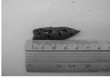
Мал. 2. Зразок синтезованого злитка Cd_2In_2Se_5
