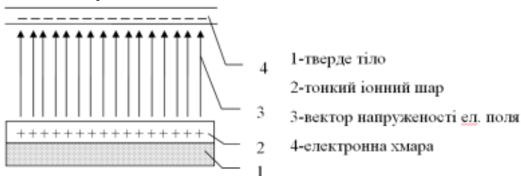
Мал. 1. Розподіл зарядів у при поверхневій області провідника
