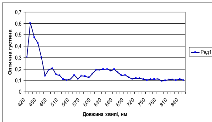
Рис. 2. Спектр поглинання плівки ZnSe
