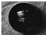
Рис. 1. Еталон германію (діаметр 3.75 см) показано пошкоджену поверхню та лінійчасту
