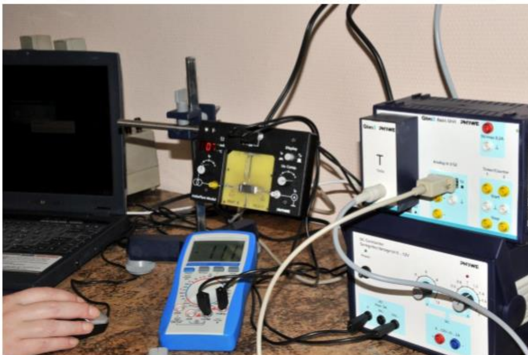
Рис. 4. Базовий блок BASIC-UNIT в лабораторній установці
