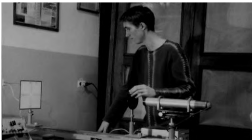
Рис. 3. Лабораторна установка для дослідження дифракції на одній щілині
