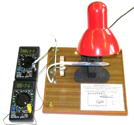
Рис. 2. Внешний вид установки по изучению температурной зависимости сопротивления термистора и определению его энергии активации
