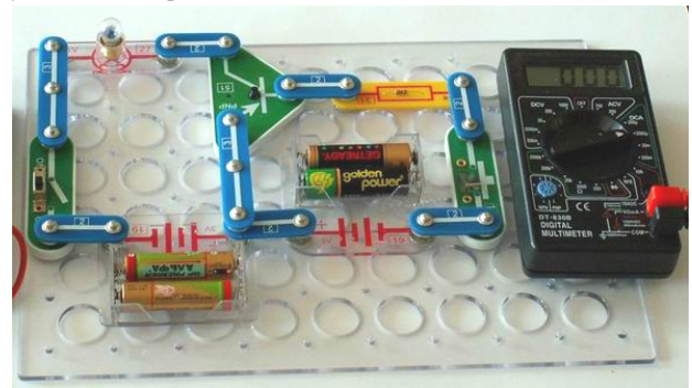
Рис. 5. Макет лабораторной работы по исследованию транзистора
