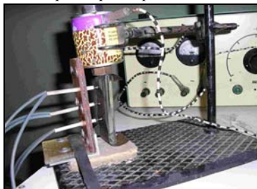
Рис. 4. Схема установки для визначення коефіцієнта теплопровідності: 1 – нагрівач; 2 – теплопровід; 3 – термопари; 4 – досліджувана пластинка; 5 – теплоізолятор; 6 – блок живлення; 7 – кварцева трубка (T 1 , T 2 , T 3 , T 4 ). Відстані між термопарами фіксовані.
