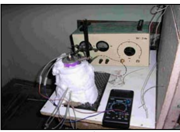
Рис. 5. Установка для визначення коефіцієнту теплопровідності: а – до теплоізолювання; б – після теплоізолювання.
