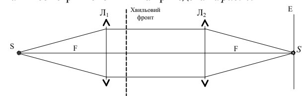
Рис. 4. Оптична схема дослід. В просторі між лінзами кювета відсутня. Пунктиром зображений переріз плоского хвильового фронту
