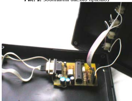
Рис. 3. Плата аналого-цифрового перетворювача в корпусі пристрою
