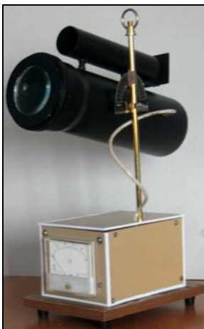
Рис. 1. Актинометр (зовнішній вид)
