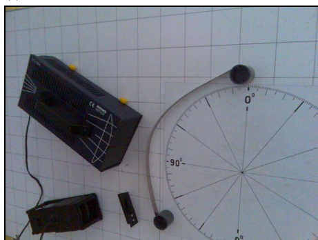
Рис. 1. Кріплення на металевій дошці лінійки з магнітами, освітлювачів та екрана-ліпучки проградуйованого у градусах
