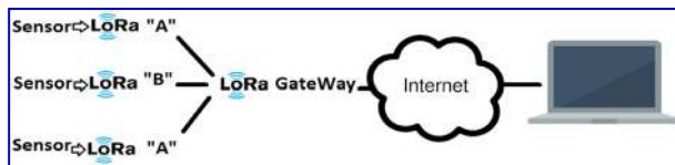
Рис. 1. Структура типової мережі LoRaWAN
