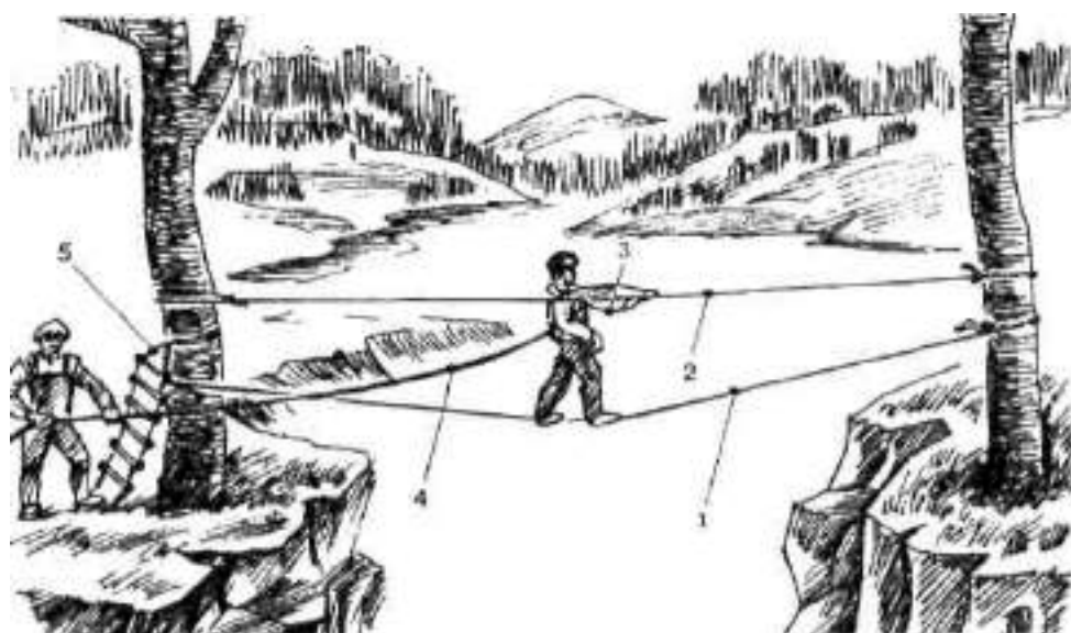
Рис. 4.17. Переправа по мотузці з перилами: 1 - основна мотузка, 2 - перила, 3 - петля із ковзаючим карабіном ("вус"), 4 - командна страховка, 5 - драбинка для підйому
