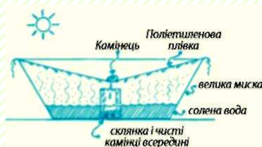
Рис. 1.18. Використання сонячної енергії для опріснення води
