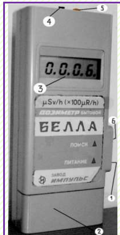
Рис. 2.32. Дозиметр «Белла»: 1 – вимикач живлення, 2 – відділ для батареї, 3 – цифрове табло, 4 – кнопка «КОТР. ЖИВЛ», 5 – індикатор напруги, 6 – вимикач режиму «ПОШУК»
