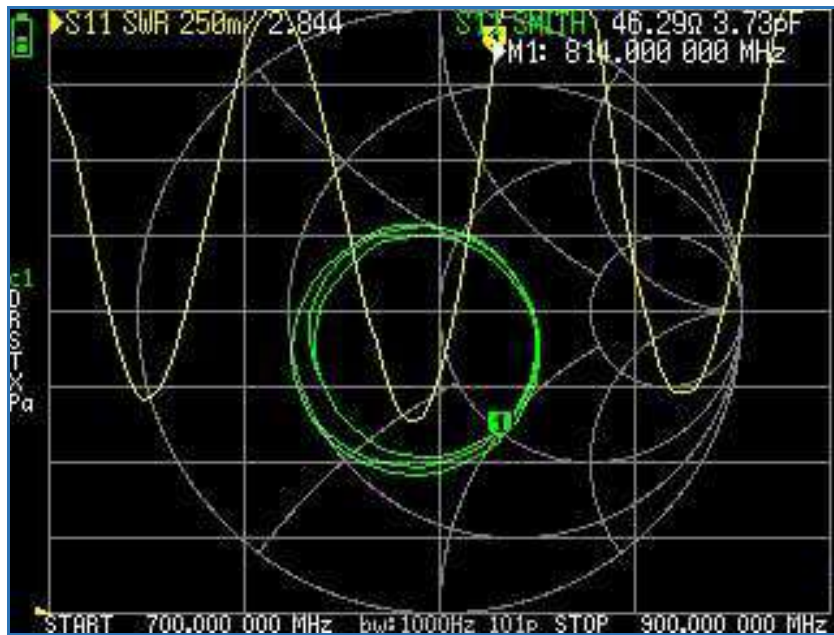
Рис. 2. Характеристика антени Фібоначі
