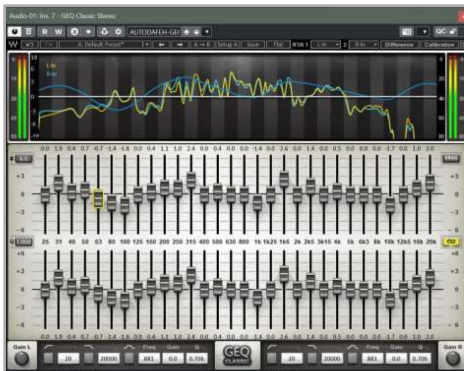
Мал. 31. Цифровий графічний еквалайзер (заснований на принципах роботи двоканального тридцятисмугового аналогового пристрою)
