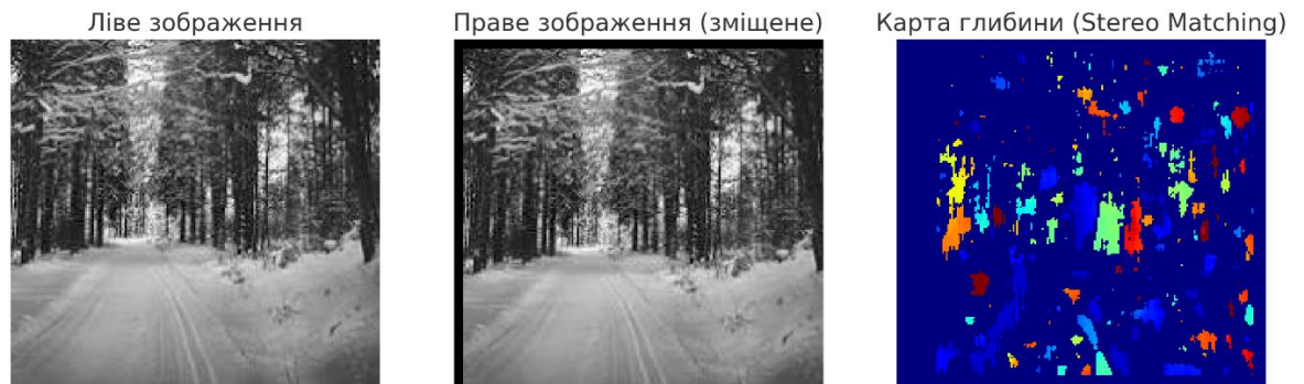
Рис.5 Демонстрація алгоритму Stereo Matching для побудови карти глибини[10].
