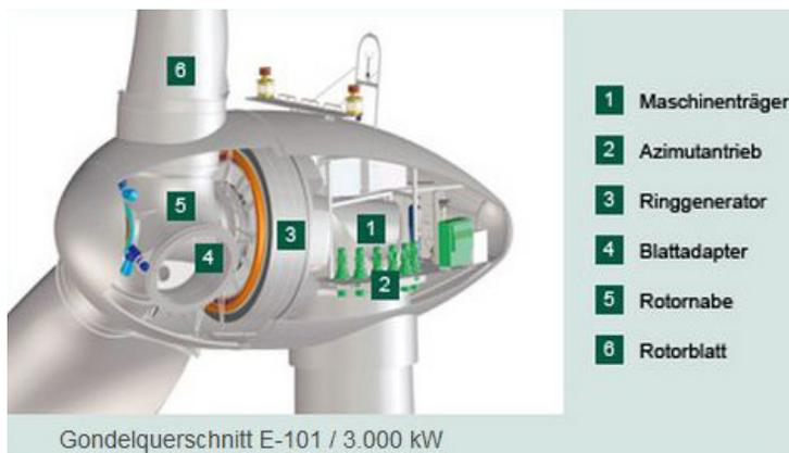
Die auftretenden <sup>17</sup>Windgeschwindigkeiten sind abhängig von der <sup>18</sup>Beschaffenheit der <sup>19</sup>Erdoberfläche. Sie nehmen mit der Höhe über dem Boden zu. Deshalb werden Windkraftanlagen möglichst hoch gebaut. Der <sup>20</sup>Rotor einer solchen Anlage <sup>21</sup>wandelt die Windenergie in mechanische Energie um. Damit wird über ein <sup>22</sup>Getriebe ein Stromgenerator <sup>23</sup>angetrieben.
