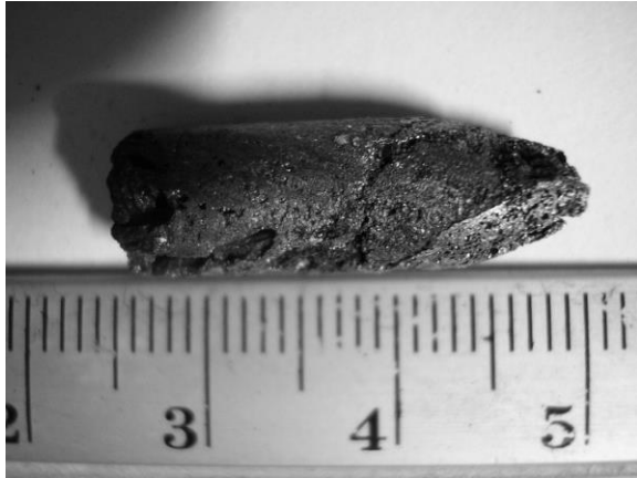
Рис. 7. Кристал, вирощений методом Бріджмена-Стокбаргера
