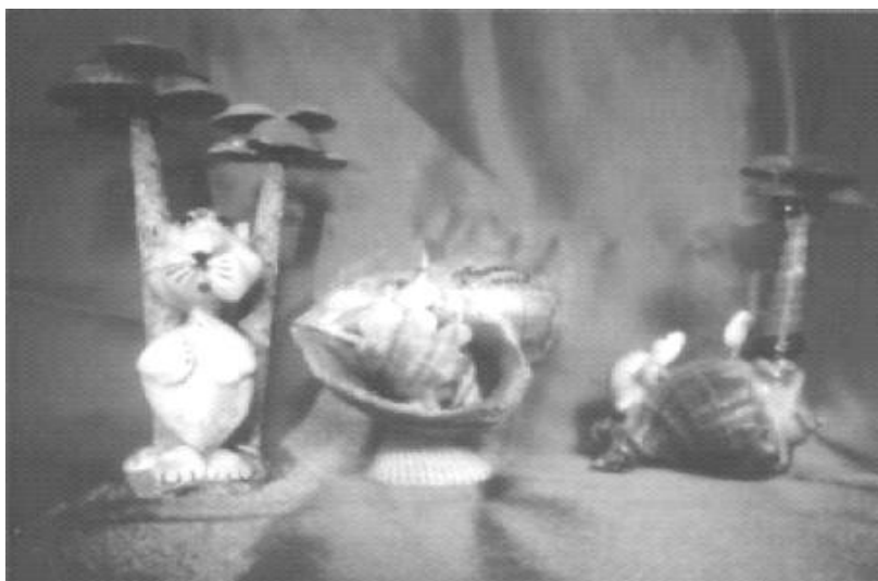
Мал. 6. Фотографія іграшок, отримана без лінзового об'єктива – роль об'єктива відіграє отвір діаметром 0,4 м.
