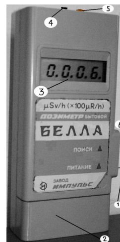
Рис. 1 – вимикач живлення, 2 – відділ для батареї, 3 – цифрове табло, 4 – кнопка «ПЕД-КОТР. ЖИВЛ», 5 – індикатор напруги, 6 – вимикач режиму «ПОШУК»
