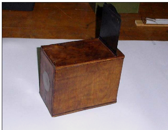
Рис. 3. Камера-обскура, изготовленная в лаборатории физики Каменец-Подольского национального университета
