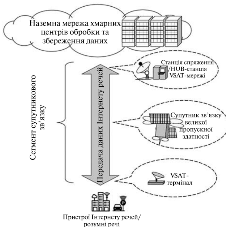
Рис. 25. Модель системи IoT, яка використовує супутникову телекомунікаційну систему
