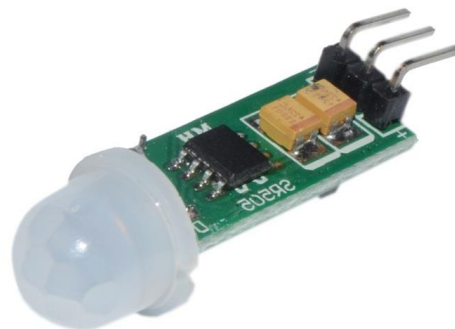
Рис. 18. Мініатюрний інфрачервоний датчик руху в безкорпусному виконанні
