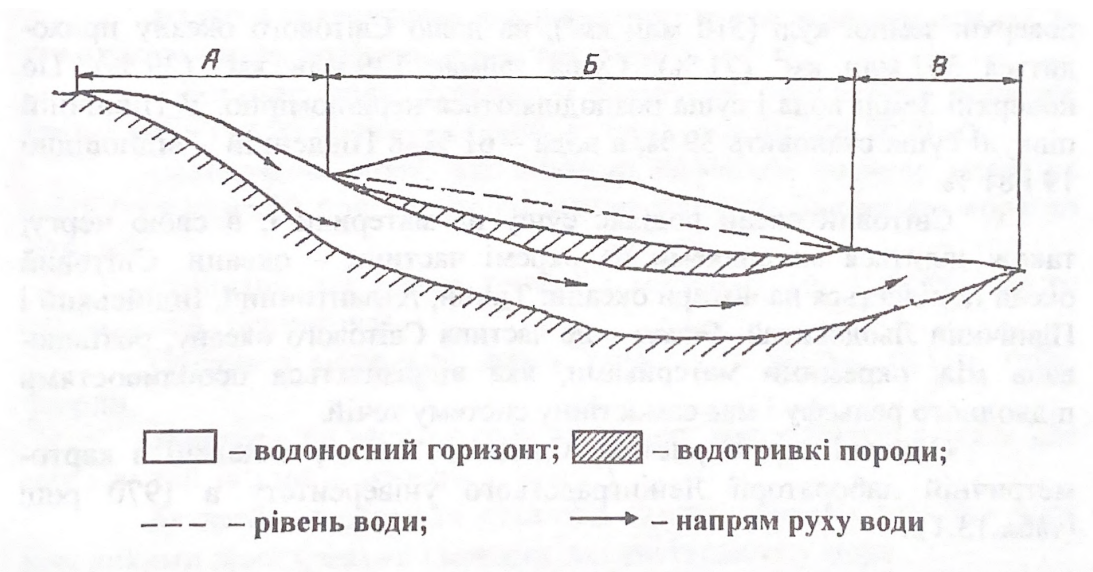
Рис. 11.2 – Схема артезіанського басейну: А – область живлення; Б – область напору; В – область розвантаження (витоку).
