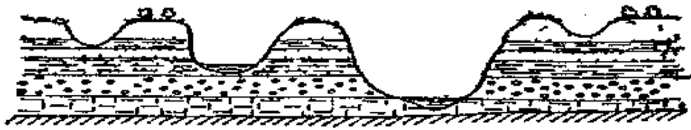
Рис. 6.1. Залежність водоносності річки від кількості перерізаних ними водоносних горизонтів
