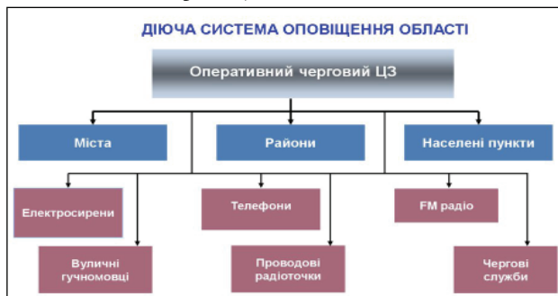
Рис. 2. Інтегрована система оповіщення.
