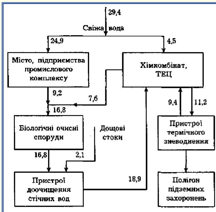
Рис. 12. Комплексна схема і баланс споживання води з використанням стічних вод хімічного комбінату, ТЕЦ, міста та підприємств промислового комплексу (цифри – витрата води в тис. м 3 /добу з вирахуванням безповоротних втрат)
